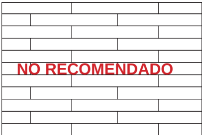
Colocación regular a Media Pieza (no aconsejable)
