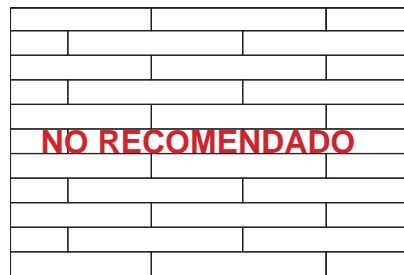
Colocación regular a Media Pieza (no aconsejable)
